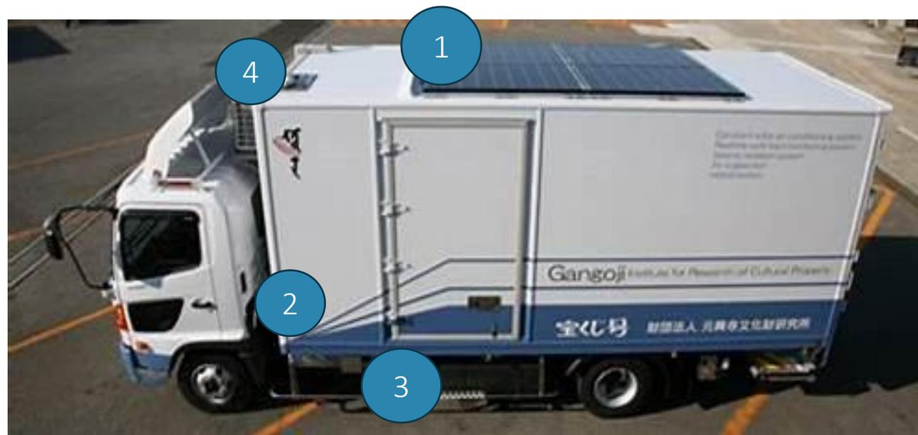
1. CIGS薄膜太陽光発電装置 KXSF W56 500W  $V_{mp}60.2V$   $I_{mp}8.32A$
